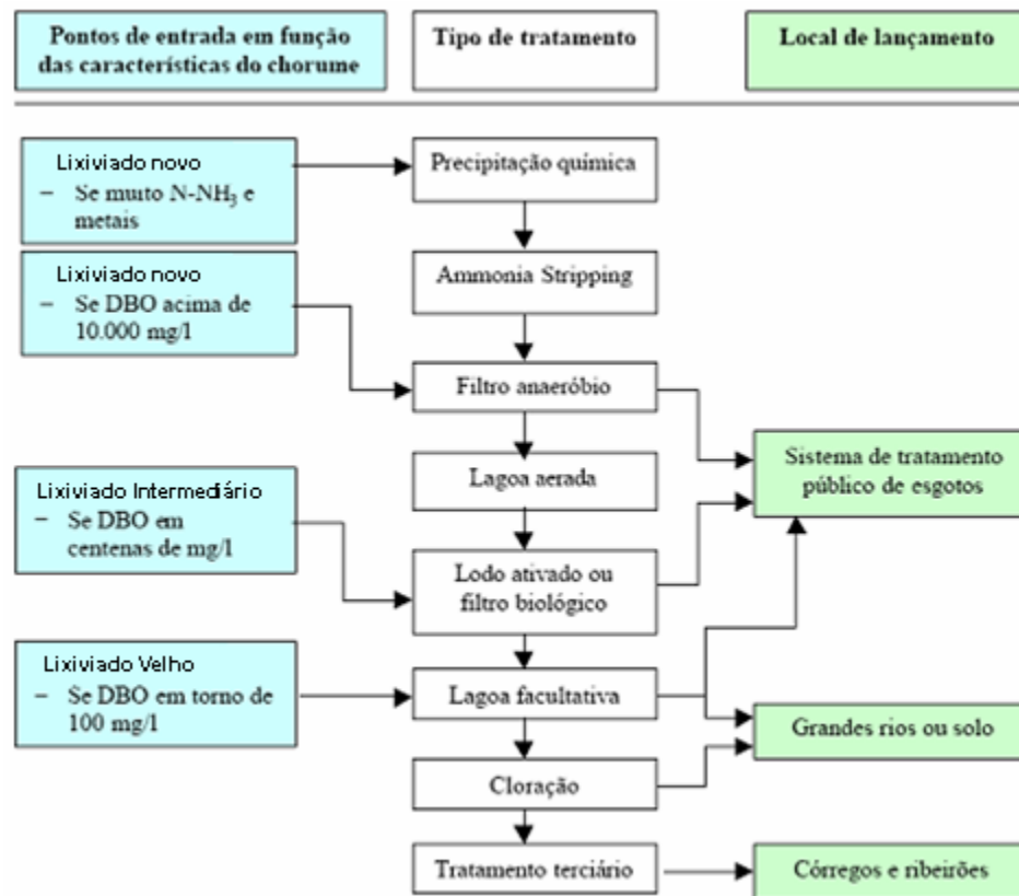
Figura 3.2 - Seleção de processos para tratamento de lixiviado.(McBEAN apud HAMADA e MATSUNAGA, 2000)
