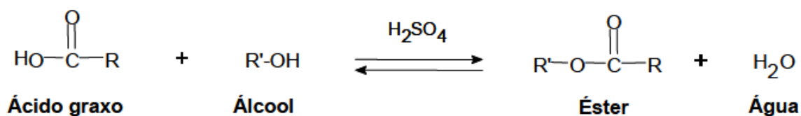
Figura 10: Reação de esterificação
