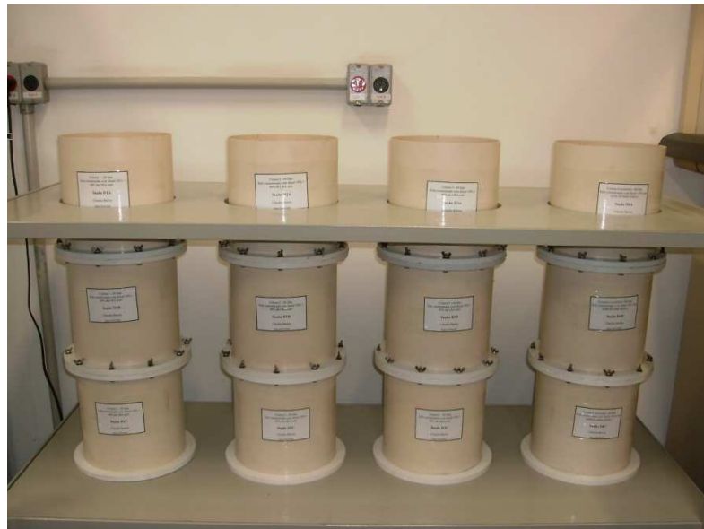
Figura 4.6. Sistemas estáticos usados nos ensaios de biorremediação dos solos contaminados com diesel (B0) e diesel/biodiesel (B4).
