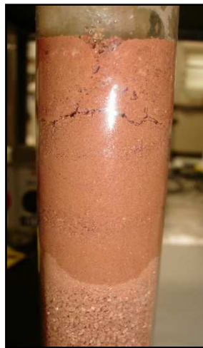
Figura 4.5. Teste de percolação de água no solo.
