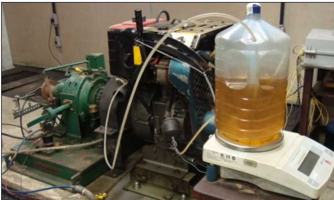
Figura 4.5: Mecanismo para medição do consumo de óleo diesel.
