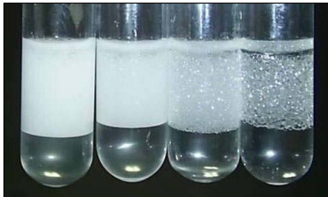
Figura 5.14 - Emulsificação do sistema n -hexadecano/solução de biossurfactante em diferentes concentrações. Da direita para a esquerda, soluções de 0,3; 0,4; 0,5 e 0,6 g/L de biossurfactante.
