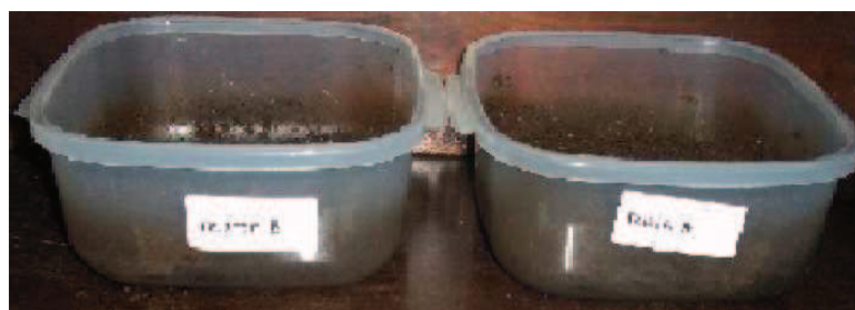
Figura 3. Reatores utilizados para realização do experimento com o solo contaminado com óleo ( in natura ).
