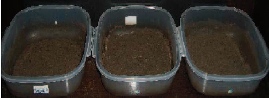
Figura 4. Recipientes de plástico utilizados para realização dos experimentos variando-se os teores do solo contaminado.
