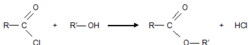
Figura 3.3 – Reação geral: Éster a partir de cloreto de acila. Fonte: SOLOMONS e FRYHLE, 2000.
