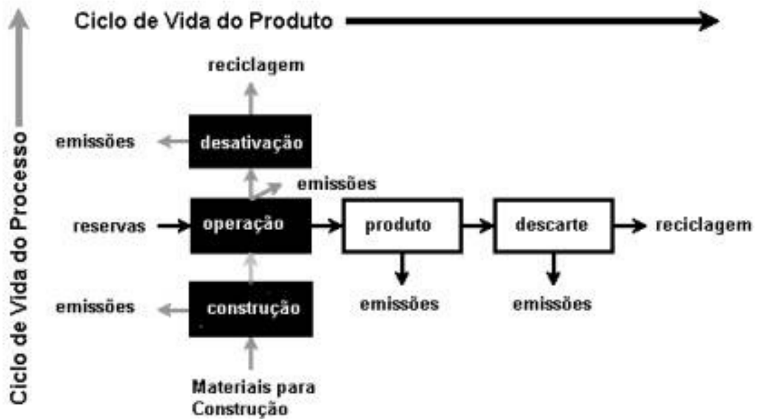
Figura III.4. Representação da Análise de Ciclo de Vida de uma indústria química considerando na horizontal o ciclo de vida do produto e na vertical, o ciclo de vida da planta industrial
